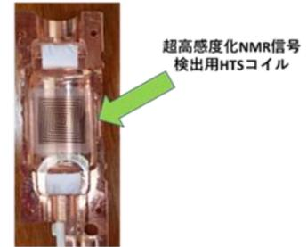
図 2 プローブヘッド部に実装している HTS コイル
