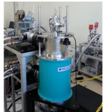
図 3 本研究開発で使用した磁場可変型超伝導磁石（高知大学）
