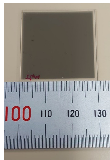
図 2 マグネトロンスパッタリングで作製した磁性体テラヘルツ光源
